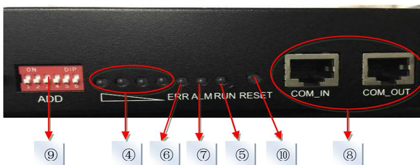
Abbildung 6: Anzeige und Kommunikationsschnittstellen
