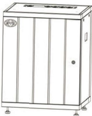
Abbildung 9: Montieren der Standfüße und Aufstellen des Gehäuses
