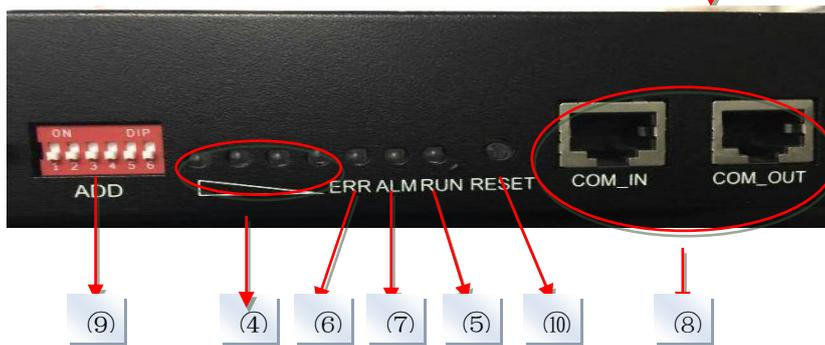
Abbildung 5: BMS Display und Kommunikationsschnittstelle
